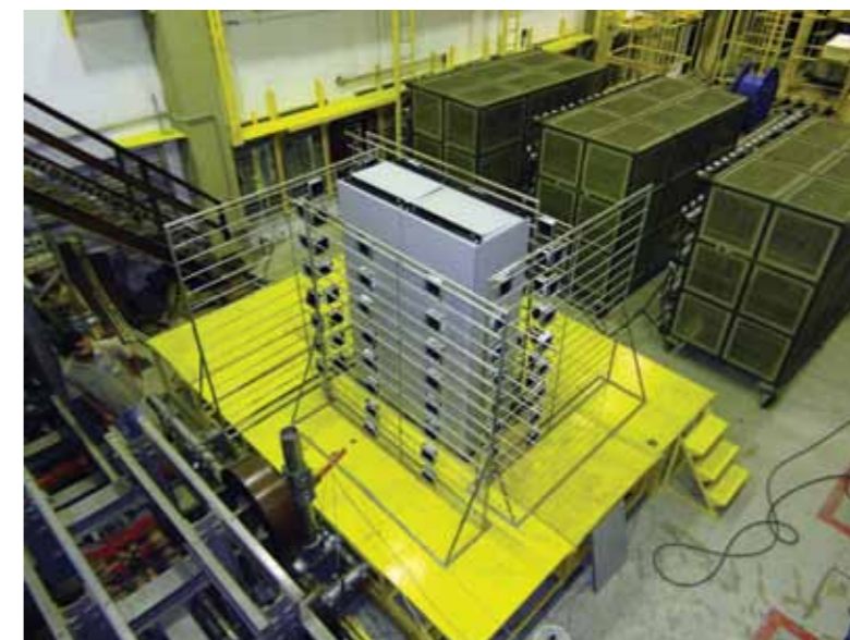
Figura 7 - Corrente suportável de curto-circuito nos barramentos
